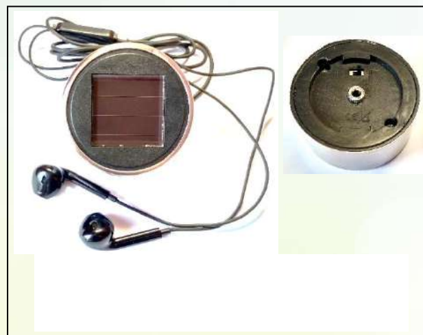
Фото 16 - Прибор для определения степени мерцания ламп.
