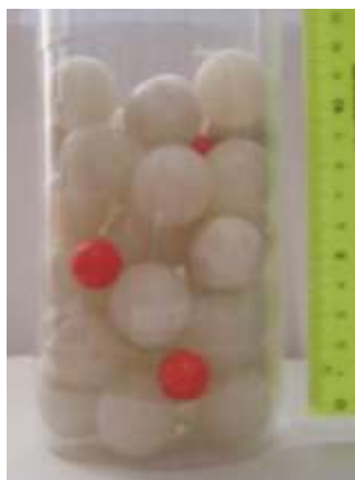
Рис. 14. Положение шариков диаметром 15 мм после четырех встряхиваний
