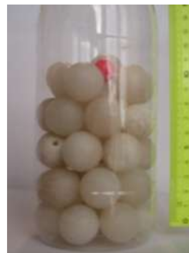
Рис. 5. Шарик диаметром 15 мм находится сверху среди шариков диаметром 25 мм
