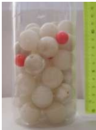
Рис. 11. Положение шариков диаметром 15 мм после одного встряхивания
