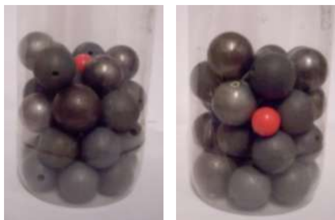
Рис. 6. Пластмассовый шарик диаметром 15 мм находится среди металлических шариков диаметром 25 мм до встряхивания (слева) и после двух встряхиваний (справа)
