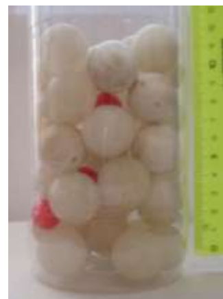
Рис. 15. Положение шариков диаметром 15 мм после пяти встряхиваний
