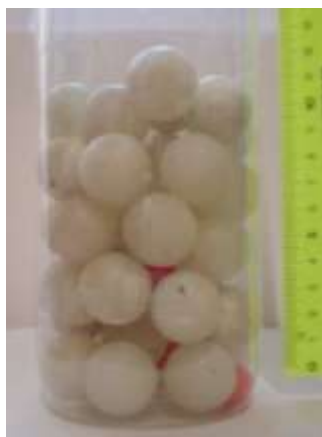
Рис. 17. Положение шариков диаметром 15 мм после семи встряхиваний
