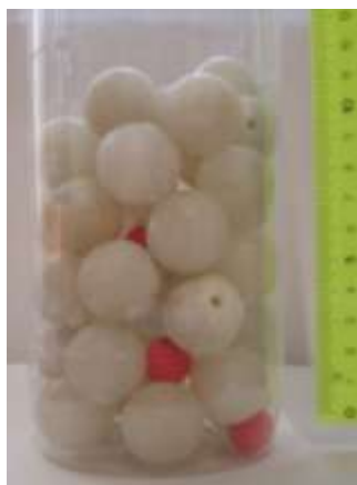
Рис. 16. Положение шариков диаметром 15 мм после шести встряхиваний
