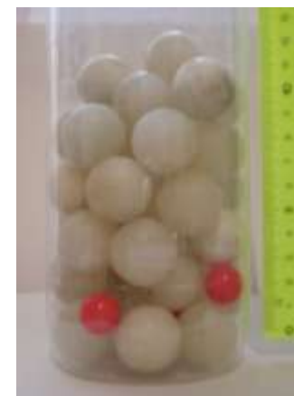
Рис. 18. Положение шариков диаметром 15 мм после восьми встряхиваний
