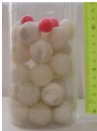
Рис. 10. Три шарика диаметром 15 мм находятся на поверхности шаров диаметром 25 мм
