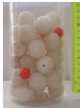
Рис. 12. Положение шариков диаметром 15 мм после двух встряхиваний
