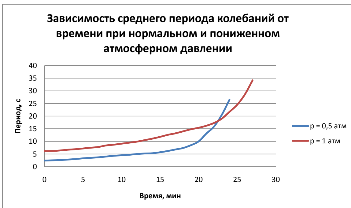
Диаграмма 4. Зависимость среднего периода колебаний от времени колебаний кусочка шоколада размером 9 мм при нормальном атмосферном давлении и пониженном давлении до 0,5 атм.
