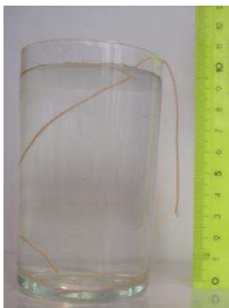
Рис. 12. Конец капроновой нити расположен ниже уровня воды в стакане
