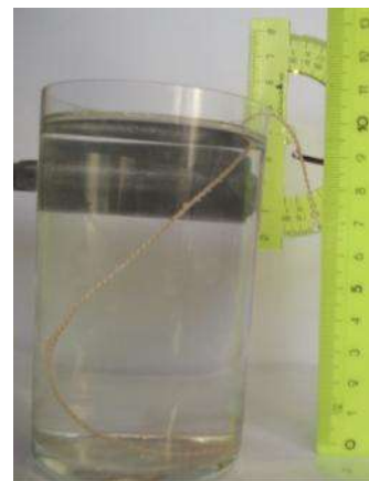
Рис. 26. Капроновая нить расположена под углом 20^\circ к вертикали на высоте 2 см
