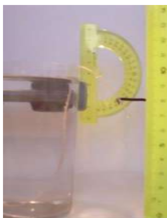
Рис. 28. Капроновая нить расположена под углом 40^\circ к вертикали на высоте 2 см
