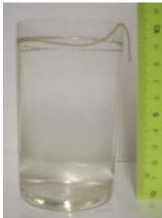
Рис. 7. Конец капроновой нити расположен ниже уровня воды в стакане
