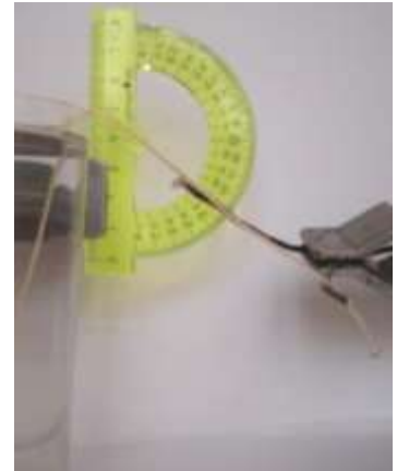
Рис. 20. Капроновая нить наклонена под углом 50^\circ к вертикали при неизменной длине
