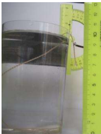
Рис. 25. Капроновая нить расположена под углом 10^\circ к вертикали на высоте 2 см
