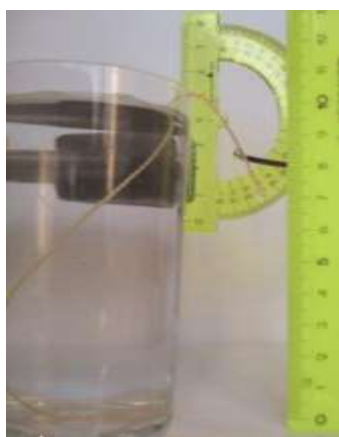
Рис. 27. Капроновая нить расположена под углом 30^\circ к вертикали на высоте 2 см
