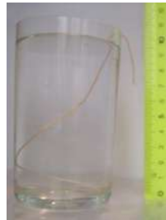
Рис. 8. Конец капроновой нити расположен ниже уровня воды в стакане
