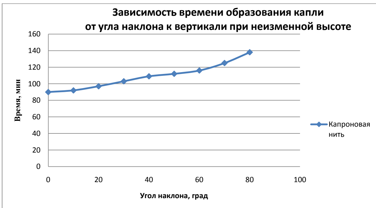
Диаграмма 4. Зависимость времени образования капли от угла наклона свисающего конца нити к вертикали при неизменной высоте свисающего конца нити h = 2 \text{ см}
