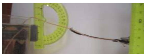
Рис. 31. Капроновая нить расположена под углом 70^\circ к вертикали на высоте 2 см
