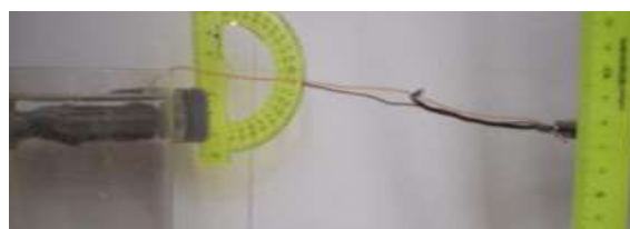
Рис. 32. Капроновая нить расположена под углом 80^\circ к вертикали на высоте 2 см
