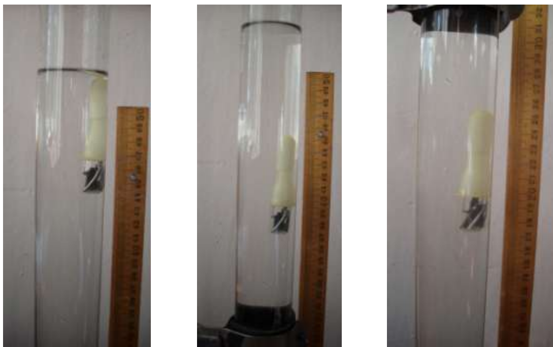
Рис. 5 Колебательное движение ампулы на границе раздела холодной и горячей воды там некоторое время, затем поднималась вверх, достигала верхней границы воды, покоилась там некоторое время, затем опять опускалась вниз и т.д., т.е. колебания не были затухающими. Этот процесс продолжался в течение 5 – 6 мин, пока температура воды существенно не изменилась.
