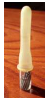
Рис. 3 Ампула с колпачком от пипетки
