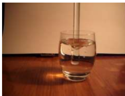
Рис. 4. Вращающийся стержень в этиловом спирте
