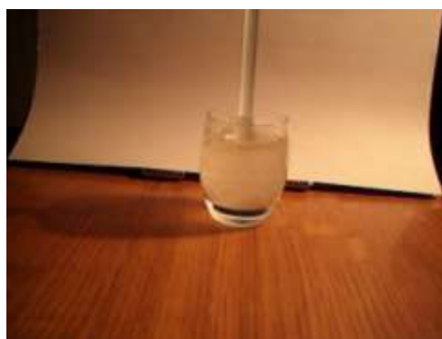
Рис. 6. Вращающийся стержень в крахмальном клейстере
