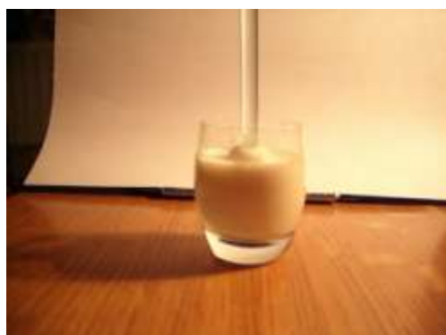
Рис. 5. Вращающийся стержень в клее ПВА
